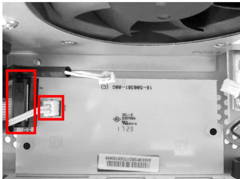
Figura 5: Retire las conexiones de la placa simulada beige
