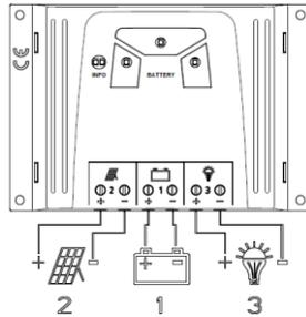
entrada máxima admisible. Primero conectar el cable de conexión del consumidor L+ en la pareja de bornes izquierda del regulador de carga (con el símbolo del módulo solar) con la polaridad correcta, entonces el cable M-. Retirar la cubierta del módulo solar.
