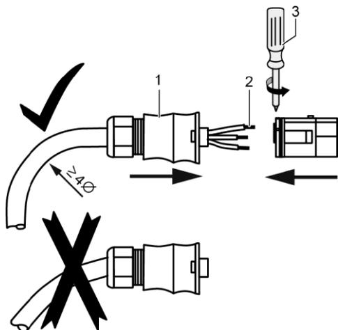
1. Conducir el cable a través de la caja del conector. Deslizar la caja del conector (1) sobre el cable.
