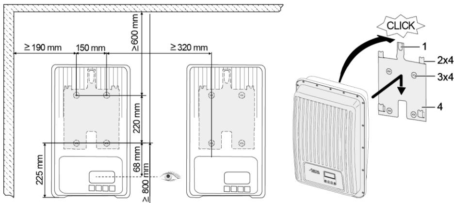
1. Fijar la placa de montaje (4) con 4 tornillos (3) en la superficie de montaje. La placa de retención (1) hacia arriba.
