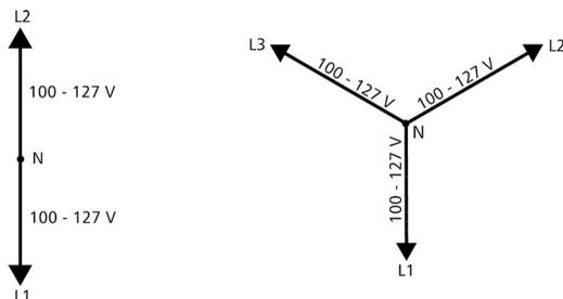
La tensión en las redes bifásicas y trifásicas es igual en cada uno de los conductores exteriores: de 100 V a 127 V.
