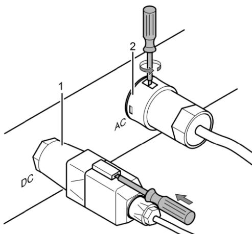
3. Desconectar la conexión CC (1) del inversor: introducir un destornillador en el orificio de desbloqueo; dejar el destornillador introducido y retirar el conector.
